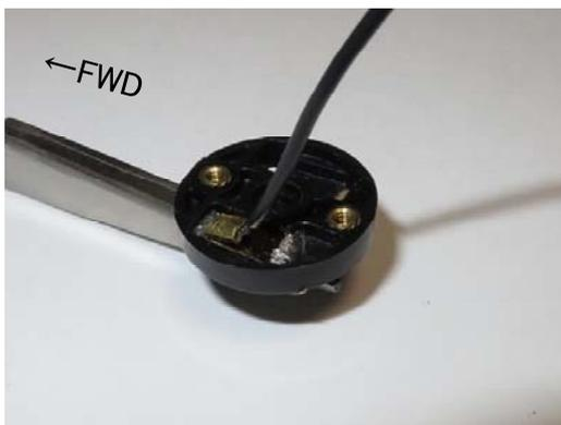
余分な平編み銅線をブレード表面から約1mm程度でニッパーでカットします
