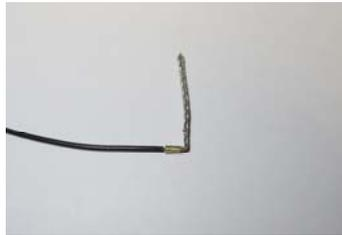
平編銅線をかしめ金具の近傍で90度に折り曲げる。
