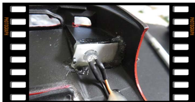
LED取付(直付け)
